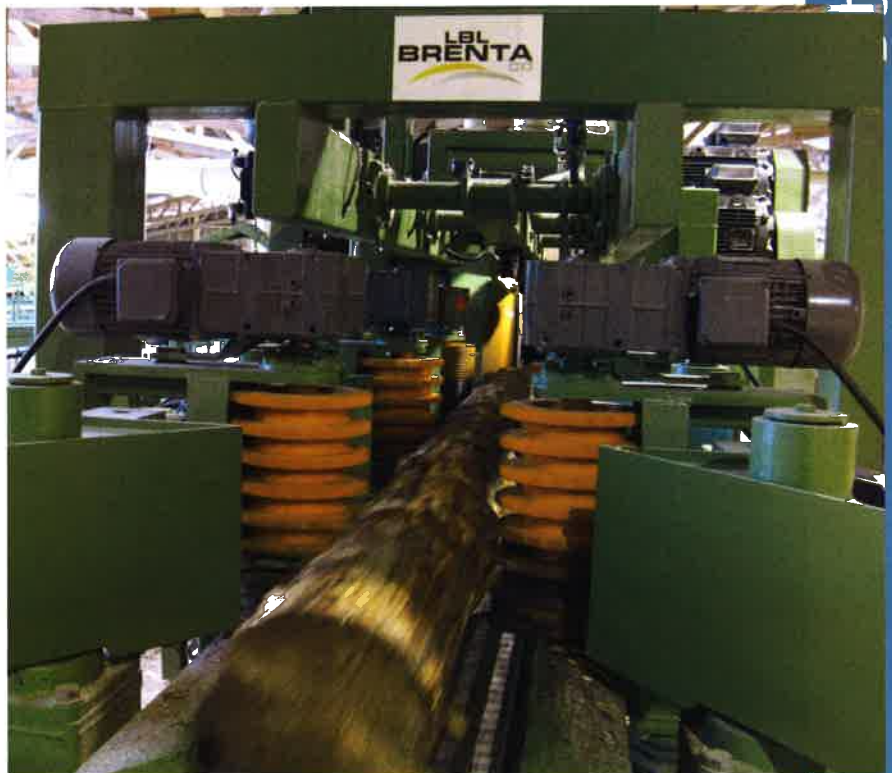
Ligne de sciage en continu canter-circulaire (Photo : LBL BRENTA).
